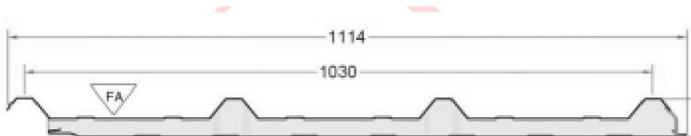
Figura 5 - Desenho esquemático de composição da telha tipo sanduiche.
